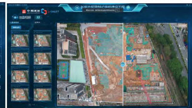
地盘相册模块：现场航拍进行周期性的形象对比
